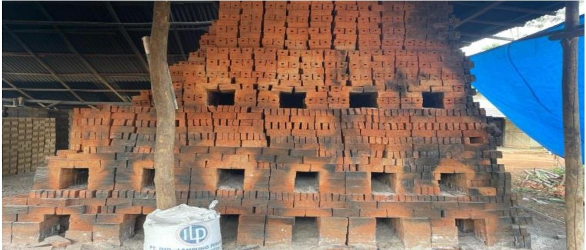
**Gambar 3.** Hasil pembuatan batu bata yang sudah di bakar.
