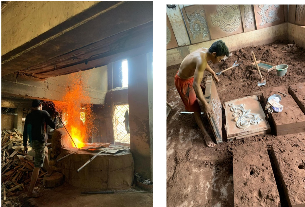
Gambar 2. Proses peleburan dan pencetakan alferum.
