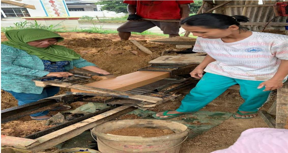
Gambar 1. Proses Pembuatan Batu Bata
