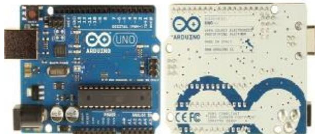
Gambar 2. papan arduino
