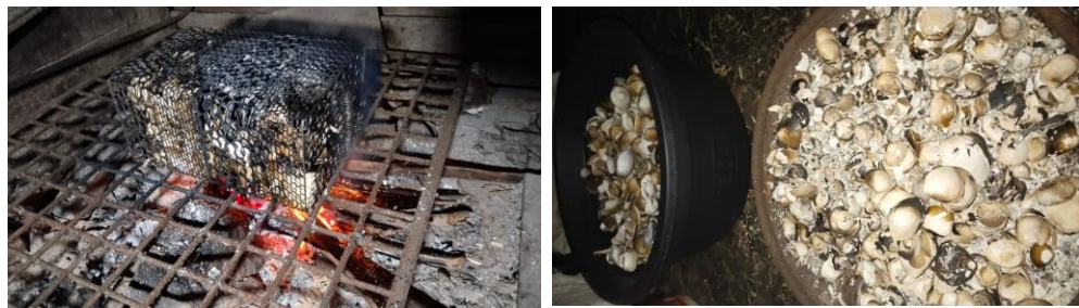
Gambar 5. Pembakaran Limbah Kerang (cangkang kerang)
