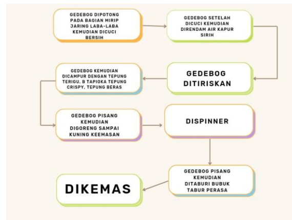
Gambar 11. Diagram Alir Pembuatan keripik Gedebog/Batang Pisang
