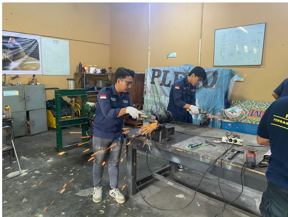
Gambar 6. Pemotongan dan perataan benda kerja
